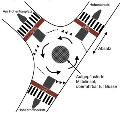
Die Mittelinsel muss aufgepflastert, aber für Linienbusse überfahrbar sein. Dies erfordert die Reduzierung von "Am Hohentorsplatz" ostwärts auf eine Spur kurz vor dem Kreisverkehr. Der durch diese Maßnahme freigewordene Raum ist zu begrünen.
