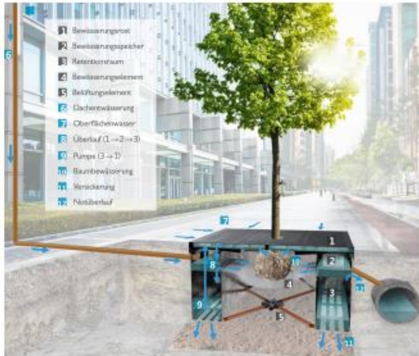
Prinzip der Speicherung und Bewässerung
